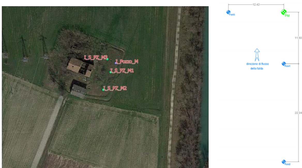
Figura 122: Ubicazione dei punti di prova e schema di disposizione dei pozzi e dei piezometri per la prova di monte, con indicazione delle relative distanze.
