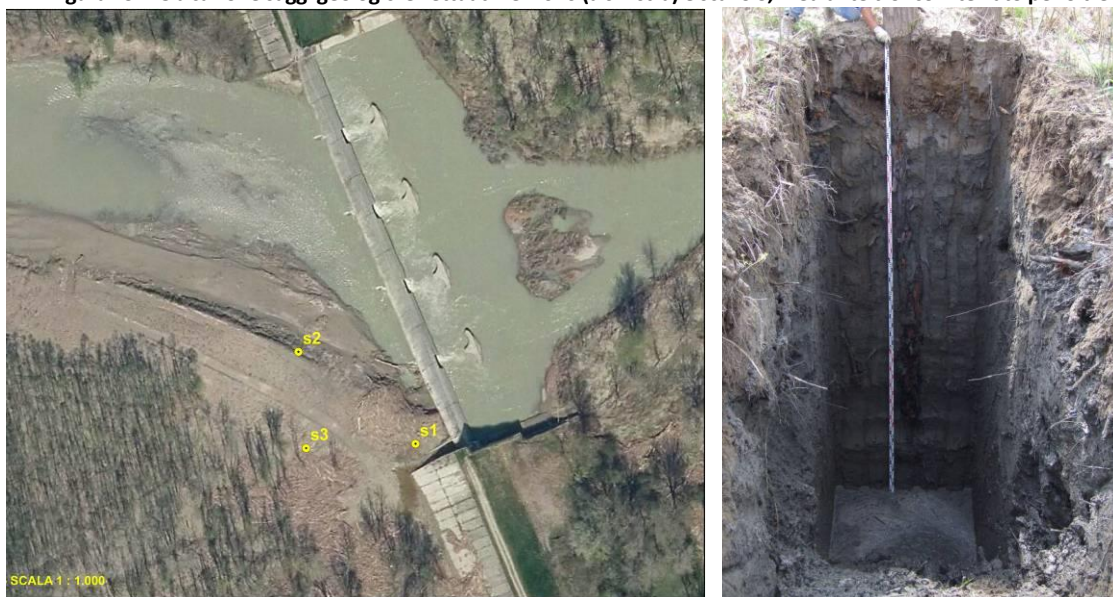
Figura 292: Ubicazione saggi geologici effettuati nel 2016 (a sinistra) e scavo 3, mediante tronco interrato per oltre 5 m (a destra).
