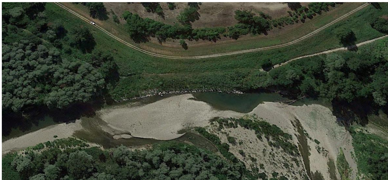
Figura 94: Vista aerea (da Google Earth) dell'erosione della sponda destra del fiume Secchia in un tratto in cui l'argine della cassa d'espansione è praticamente in froldo.
