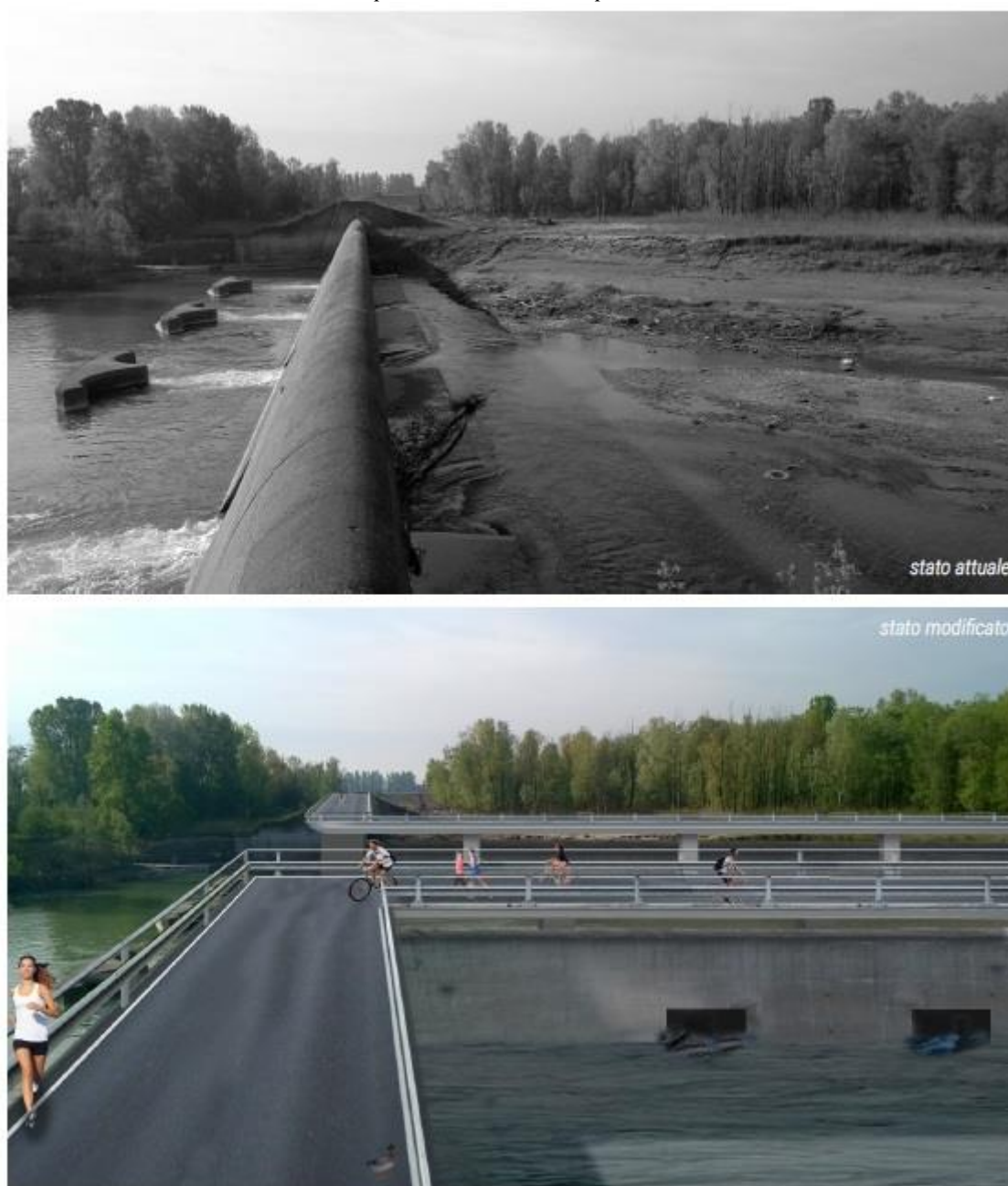
Figura 305: Simulazione n.2 – stato attuale e di progetto a confronto del manufatto regolatore, con dettaglio del nuovo percorso di servizio sopraelevato.
